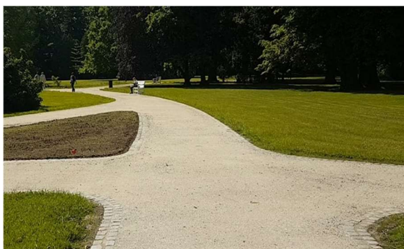
Ilustrační obrázky komunikace s povrchem z mlatu a obrubou z žulové kostky.
